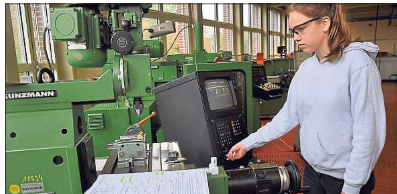
Den Umgang mit modernem Arbeitsgerät lernte Lea Vennea, die bei der CNC-Maschine die Koordinaten einstellen muss, damit die Maschine das Bauteil an der gewünschten Stelle anbohrt.
